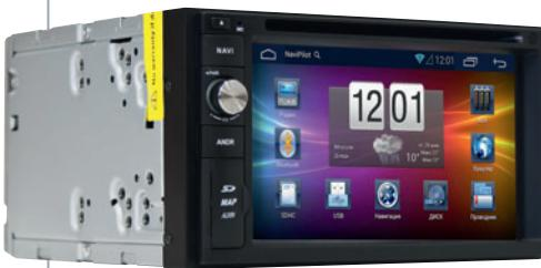
Пластиковая передняя панель сделана несъемной. Слева от дисплея расположены основные органы управления: клавиша извлечения диска, многофункциональная ручка, а также две кнопки, отвечающие за систему навигации и переключение интерфейса.
