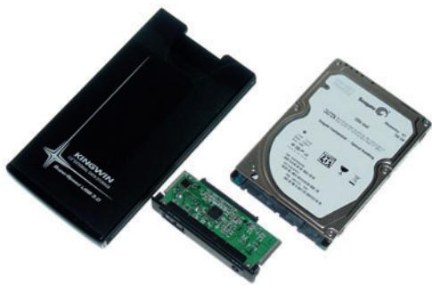
**Большинство внешних дисковых контейнеров имеют прочный корпус и небольшую плату, к которой подключается накопитель**
