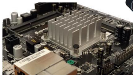
В системе стабилизации питания использованы твердотельные конденсаторы японского производства и катушки с ферритовыми сердечниками, что, по мнению производителя, должно существенно повысить надежность системной платы.
