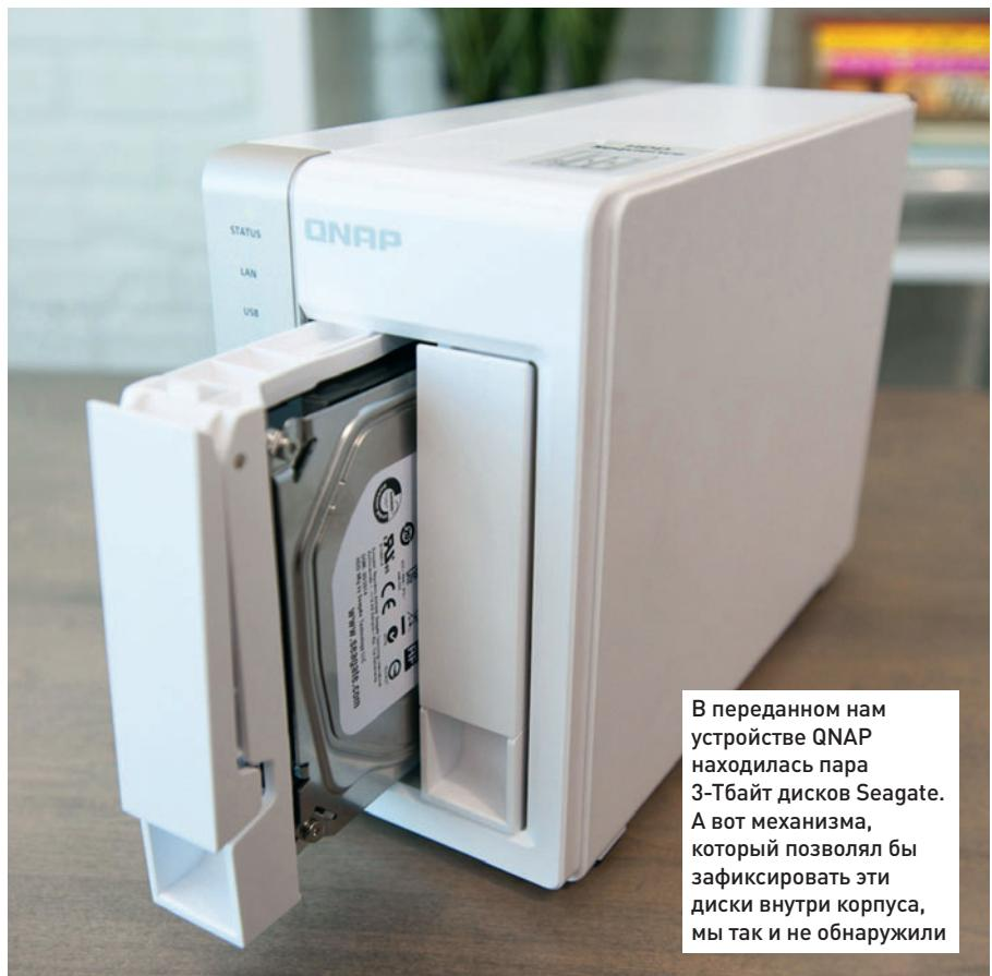
В переданном нам устройстве QNAP находилась пара 3-Тбайт дисков Seagate. А вот механизма, который позволял бы зафиксировать эти диски внутри корпуса, мы так и не обнаружили
