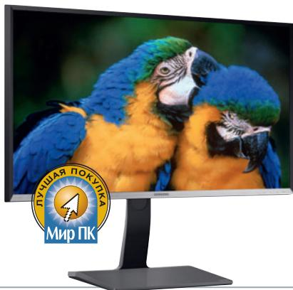
IPS), отличающейся невысоким энергопотреблением. К ее недостаткам относится не самое быстрое время реакции пикселя. Дисплей имеет диагональ экрана 31,5 дюйма и соотношение сторон 16:9. Заявленный угол обзора, как по горизонтали, так и по вертикали, составляет 178°. Поскольку U32D970Q ориентирован, в первую очередь, на профессионалов, матрица поддерживает честный 10-битный режим с широким цветовым охватом.
